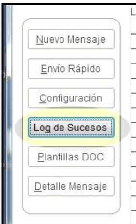
Cuando por algún motivo se produce un error en el envío de los mensajes, se guarda en el “Log de Sucesos” un ítem con el código de error proporcionado, útil para luego determinar el origen del problema.
